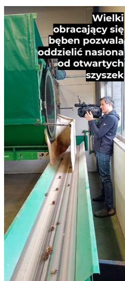
Uzupełnianie maszyny łuszczącej nasiona z szyszek sosnowych
